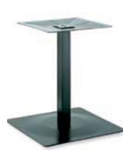
TG.515.02 Tischgestell schwarz beschichtet H = 700 mm Geeignet für Platten bis 1000 x 1000 mm Bodenplatte 625 x 625 x 5 mm
