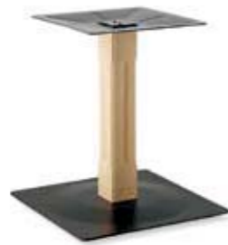
TG.515.0213 Tischgestell schwarz beschichtet H = 700 mm Geeignet für Platten bis 1000 x 1000 mm Bodenplatte 625 x 625 x 5 mm Vierkantsäule Buche roh geschliffen
