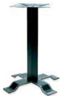
TG.305.03 Tischgestell schwarz mit geschmiedetem Rand H = 700 mm Geeignet für Platten bis 800 x 800 mm Bodenplatte 550 x 550 mm
