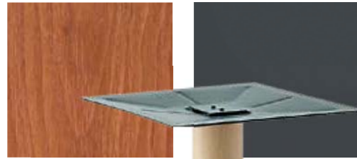
TG.515.0216 Tischgestell schwarz beschichtet H = 700 mm Geeignet für Platten bis 1000 x 1000 mm Bodenplatte 625 x 625 x 5 mm Rundsäule Buche roh geschliffen
